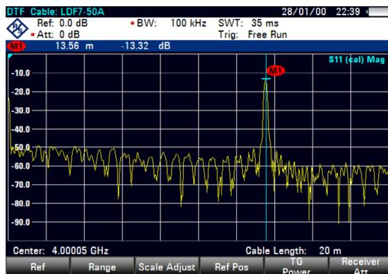
Una línea azul vertical representa la posición del marcador en el eje horizontal (por ejemplo, la frecuencia).
