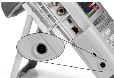
El R&S ZVH se suministra con corriente de un transformador de alimentación CA/CC conectado a la conexión CC. También puede utilizar el conector CC para cargar la batería.
