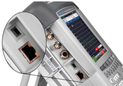
Puede conectar el R&S ZVH a un PC vía USB o LAN y transferir datos en ambas direcciones.
