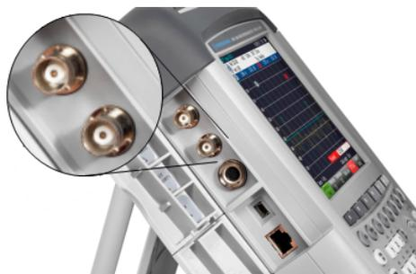
Puede configurar ambos conectores BNC para varias aplicaciones. Los nombres de las conexiones están grabados en el interior de las tapas protectoras.
