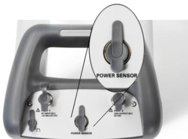
La conexión está específicamente configurada para sensores de potencia. Se usa tanto para alimentar el sensor como para transferir datos a través del interfaz del sensor de potencia.
