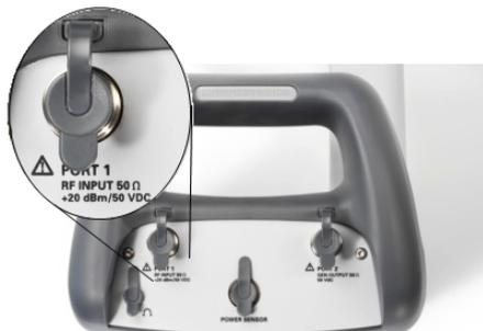
Conecte un cable o DUT a la entrada de RF con un conector N. Utilice un cable para conectar el DUT al R&S ZVH, si fuera necesario. Asegúrese de no sobrecargar el R&S ZVH.
